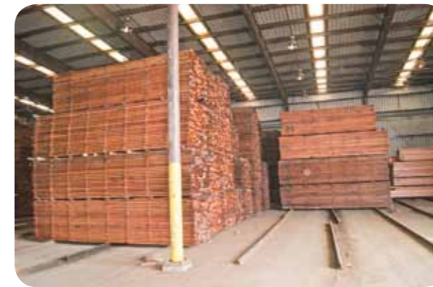
Em seguida vem a secagem em estufa, onde as madeiras ficam de duas semanas a um mês, até atingirem entre 6 e 8% de umidade. São 20 estufas com 150 m 3 cada
